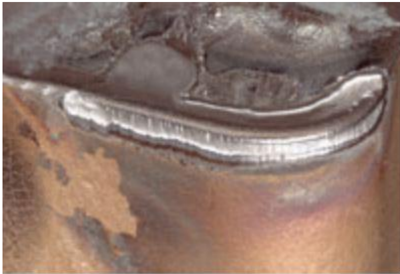
Figura 23 - Desgaste de flanco [21].
