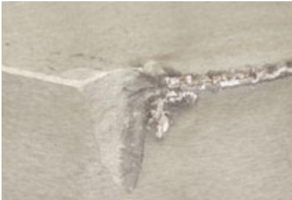
Figura 21 - Desgaste de entalhe [21].
