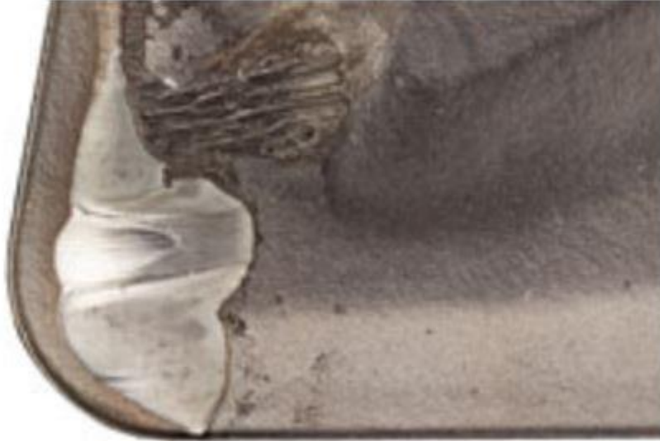
Figura 20 - Desgaste de cratera [21].
