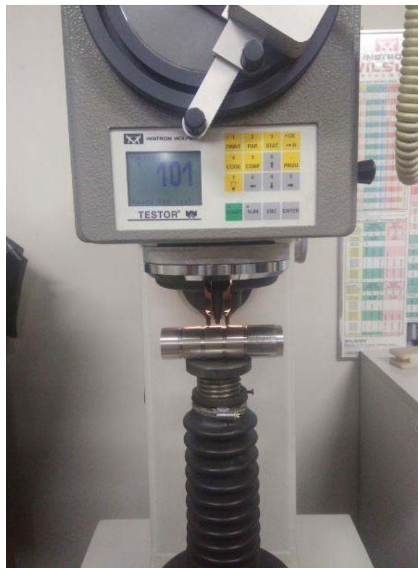
Figura 32 - Durômetro INSTRON WOLPERT durante um ensaio de dureza Rockwell.
